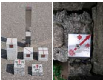
境界を示す標識となる境界標。杭の頭部には点や線、矢印など、境界の位置を特定する印が付けられている
