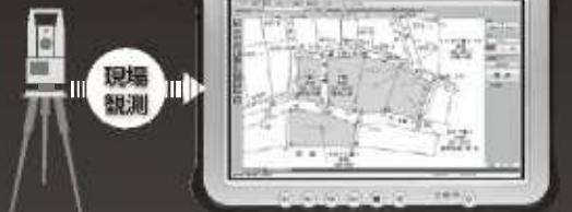
現地での確認メモ記録、写真撮影、観測まで1台でまとめて行え、デジタルデータでの情報収集が成果作成を強力にサポートします。
